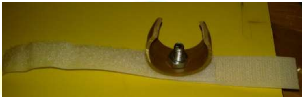
Figura 40. Visualização da montagem final do sistema de braçadeira na mesa.
