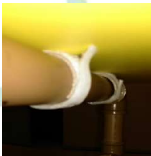
Figura 41. Visualização das braçadeiras acopladas com o velcro sobre os braços da carteira.
