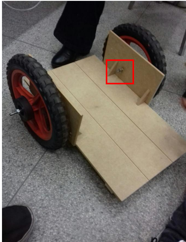
Figura 9: Instalação das rodas laterais da cadeira de rodas.
