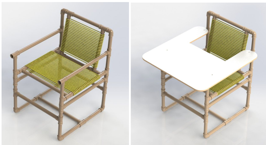
Figura 4. Renderização da montagem completa da cadeira escolar sem e com a mesa.
