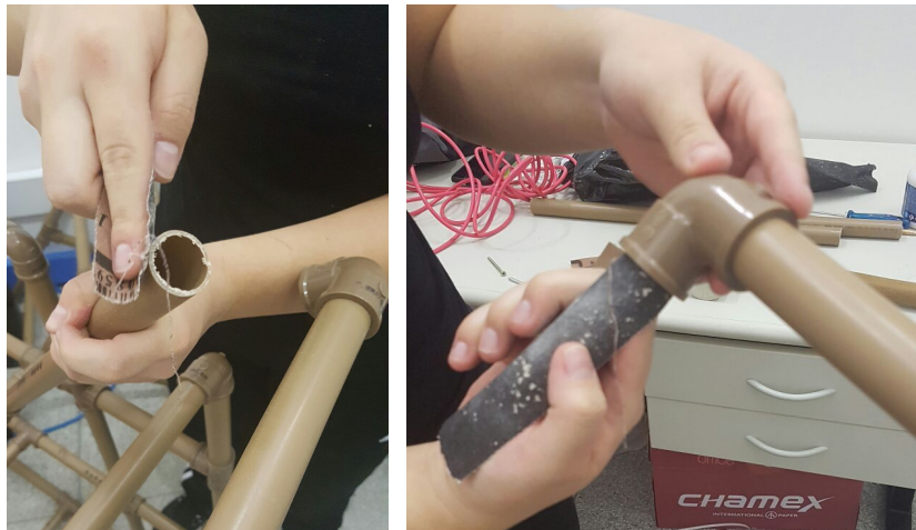
Figura 2 - Lixar as regiões onde serão feitas as conexões permite melhor adesão da cola.
