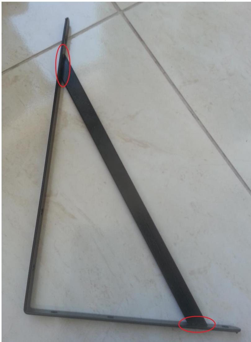
14. Apoiar a base de madeira sobre os canos de comprimento D1, deixando-a encostada no cano do apoio. Apoiar a mão francesa sobre a madeira, encostando-a também no cano de apoio, com uma canetinha, marcar os furos na base de madeira e no cano do apoio. Repetir no outro lado.
