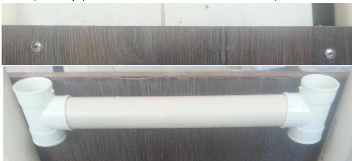
19. Para melhor fixar o parafuso no cano, colar com superbonder ou utilizar um termo retrátil, aquecendo-o com um isqueiro ou soprador térmico para fixá-lo no parafuso.
