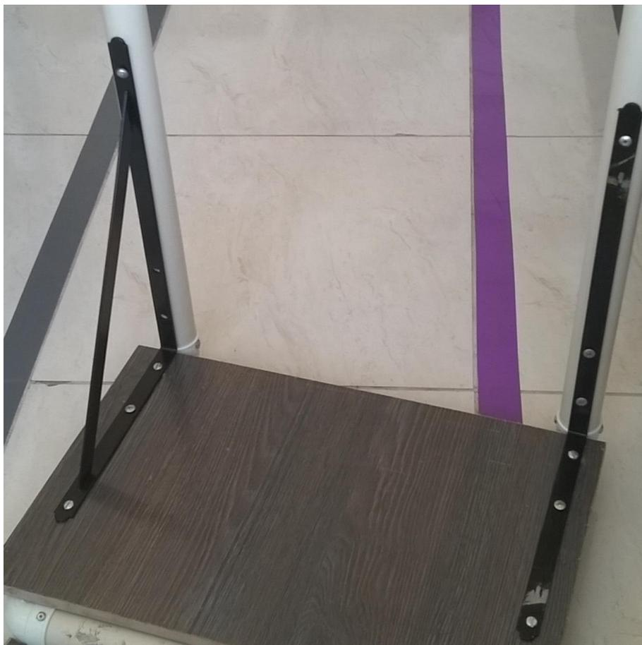
18. Com o cano de comprimento D3 que sobrou, conectar dois “Tês” e fixar na parte de baixo da base de madeira para reforçar, furando com o ferro de solda ou furadeira no cano, e na madeira com a furadeira.
