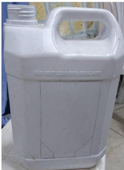
Aqueça a faca e corte a embalagem seguindo o padrão desenhado. Utilize uma lima ou lixa para retirar as rebarbas laterais. Meça no EVA uma cobertura para a nadadeira e cole-a com ajuda da cola de contato.
